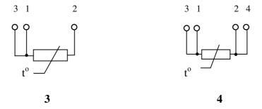
Рисунок 2. Схемы соединения чувствительного элемента  $TC\Pi$  002-06
